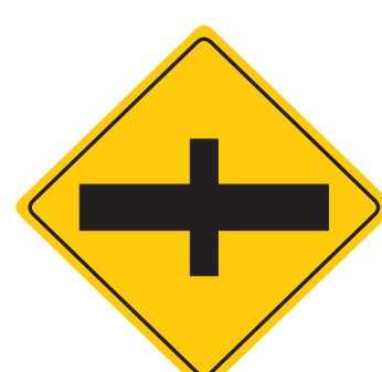
P-12 INTERSECCIÓN EN ÁNGULO RECTO CON VÍA PRIMARIA
