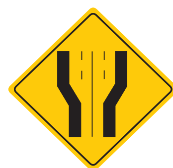
P-22 ENSANCHE DE LA CALZADA
