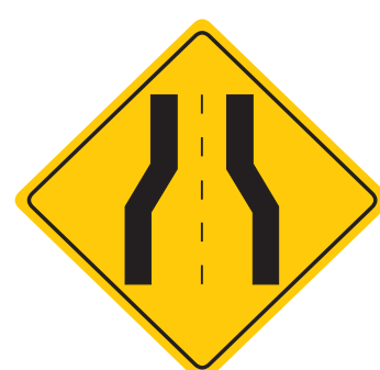
P-17 REDUCCIÓN DE CALZADA
