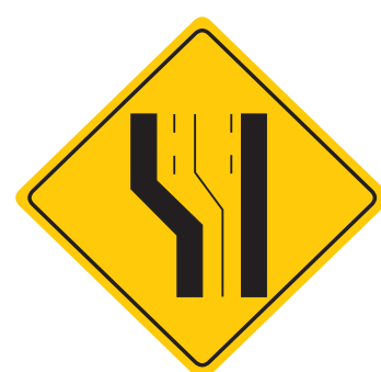
P-23 ENSANCHE DE LA CALZADA
