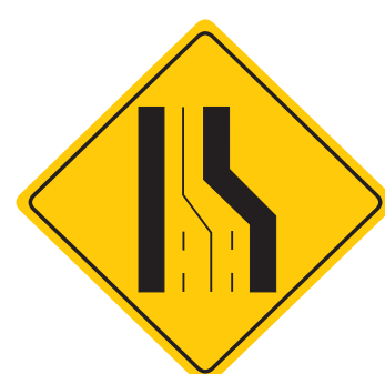
P-19 REDUCCIÓN DE CALZADA
