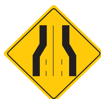
P-18 REDUCCIÓN DE CALZADA
