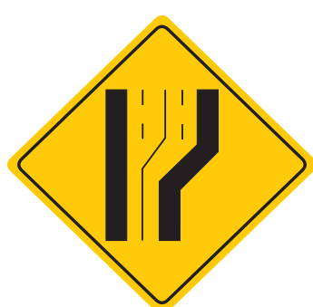
P-24 ENSANCHE DE LA CALZADA
